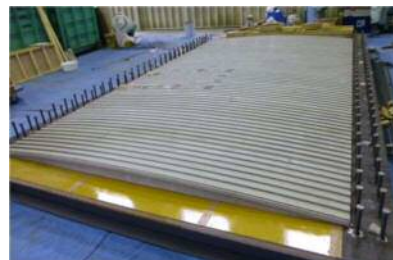
写真-1 押し出し成形板（リブ付きアーチ形状） 1)
