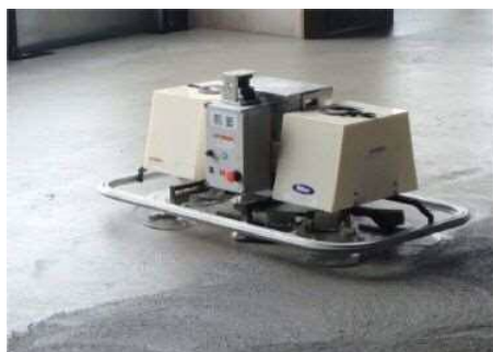
写真 2-6 仕上げロボット T-iROBO Slab Finisher1
