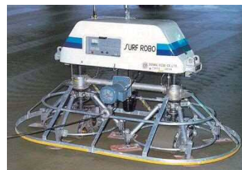
写真 2-10 仕上げロボット サーフロボ
