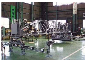
写真 2-9 均しロボット スクリーードロボ
